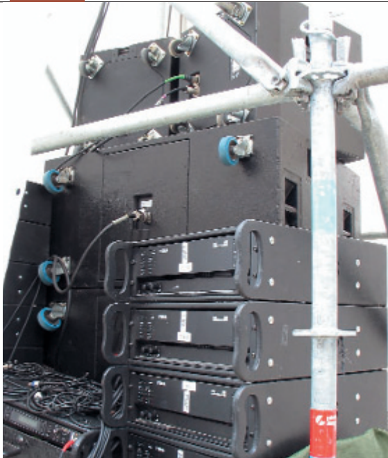
Subwoofer, Frontfills und Endstufen von d&b in einem Tower neben der Rundbogenbühne
