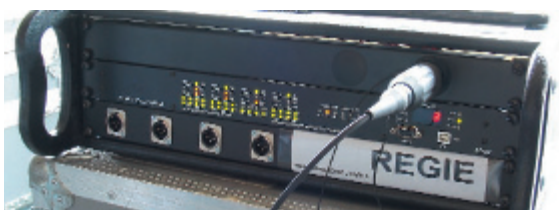
Die digitalisierten Audiosignale werden mit Hilfe eines Optocore-Systems per LWL übertragen
