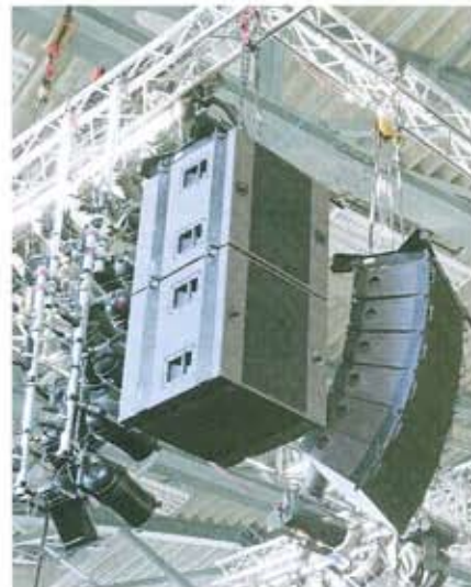
Links und rechts der Bühne wurden Arrays aus jeweils sechs dV-DOSC-Einheiten in Kombination mit zwei dV-SUBs geflogen
